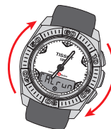
Obrócić zegarek wokół jego własnej osi o więcej niż jeden pełny obrót w płaszczyźnie poziomej (np. na stole), w miejscu bez zakłóceń magnetycznych, z prędkością obrotową około 30° na sekundę. Całkowity czas czynności: maksymalnie 20 sekund
